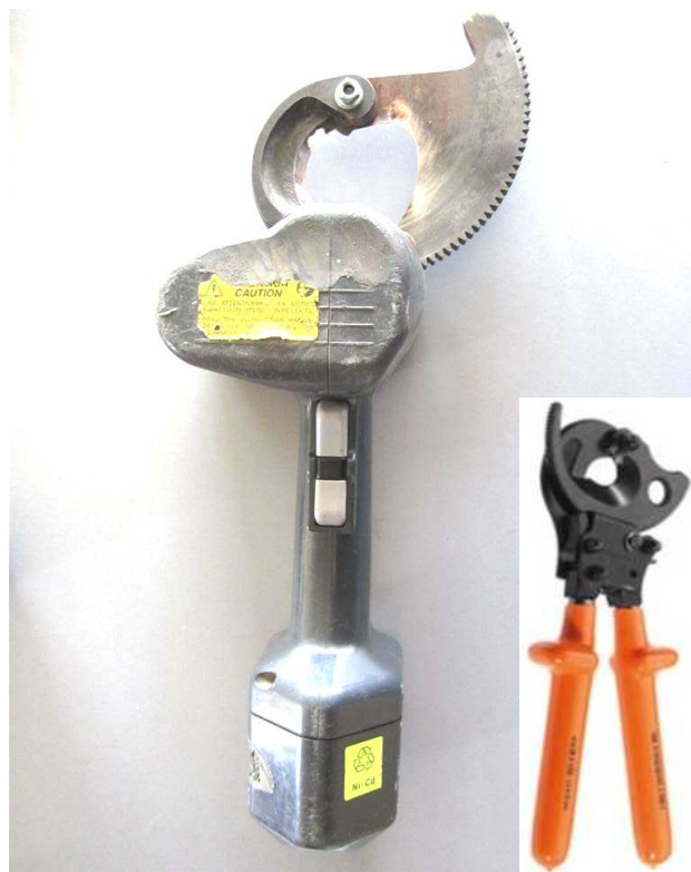
Coupe-câble endommagé par le court-circuit
